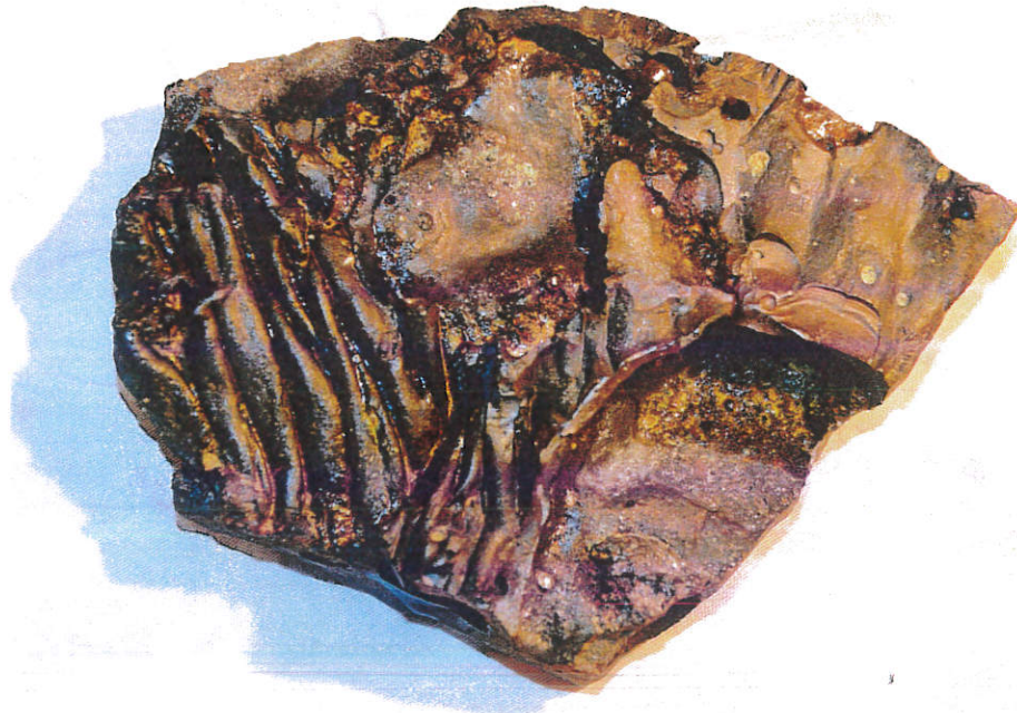
Schlacke aus mittelalterlicher Eisenerzverhüttung in Rennöfen
